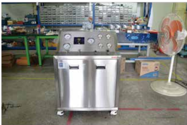
丙烷(C 3 H 8 )和氩气(Ar)增压、 填充和注入设备
