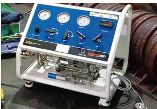
水压测试设备
