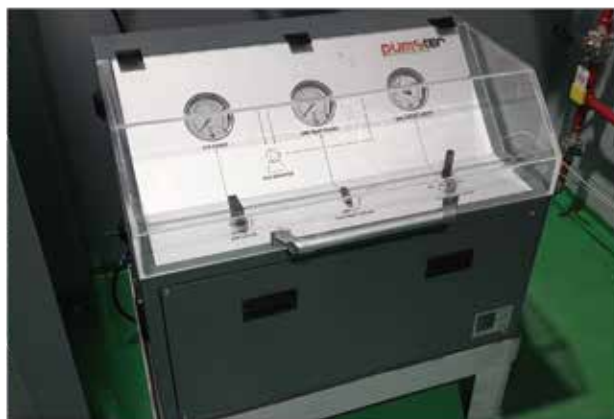
氢气(H 2 )增压设备
