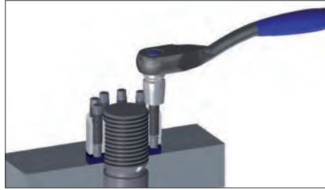
Zentrierung der Scheibe auf dem Gewinde Achten Sie darauf, dass die Scheibe plan aufliegt und genau mittig auf dem Bolzen sitzt.
