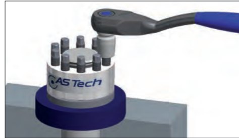
Spannmutter am Bolzenende Damit die Sechskantmutter durch eine Spannmutter ersetzt werden kann, könnte eine Distanzscheibe erforderlich sein. Dies gewährleistet, dass ein Drehmomentschlüssel eingesetzt werden kann.
